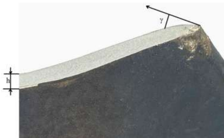
Рисунок 3.5 – Товщина лапи і кут заточування робочої поверхні: h = 5-7 мм висота, \gamma = 25-35^\circ кут
