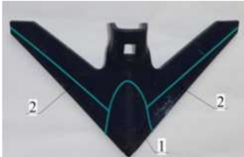
Рисунок 1.12 – Схема нанесення зносостійкого покриття на робочу поверхню стрілчастої лапи для досягнення ефекту самозагострювання та рівностійкості зношування: 1, 2 – зона інтенсивного та помірного абразивного зношування відповідно
