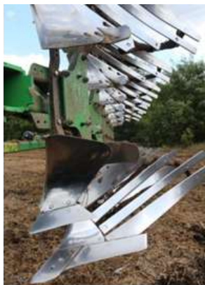
Рисунок 1.2 – Елементи робочих органів плугів, які піддаються інтенсивному зношуванню
