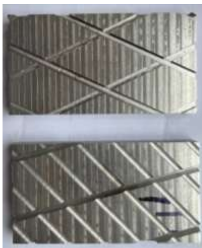
Рисунок 3.8 – Процес деформації металу (алюміній Al6) під оглядом елементарних ділянок
