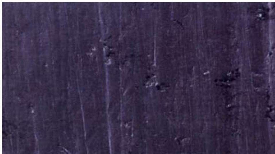
Рисунок 1.5 – Поверхня носка лемеша, який працює в умовах суглинкових та глинистих ґрунтів
