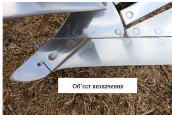
Рисунок 1.2 – Елементи робочих органів плугів, які піддаються інтенсивному зношуванню
