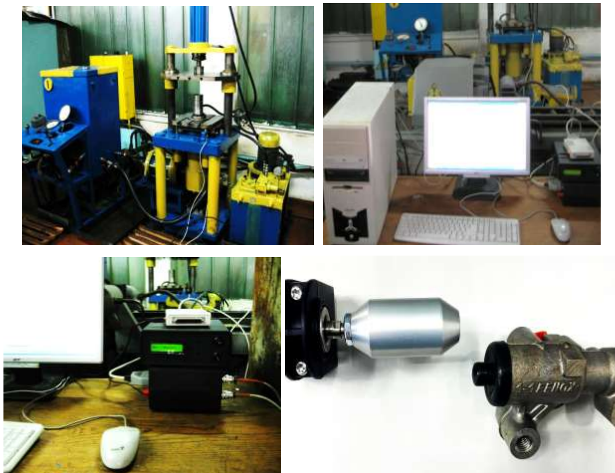
Рисунок 3.6 – Світлини експериментального стенда гідроімпульсного приводу
